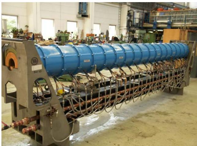
Abbildung 139: LINAC II Ersatzabschnitt in der MEA4-Montagewerkstatt.
