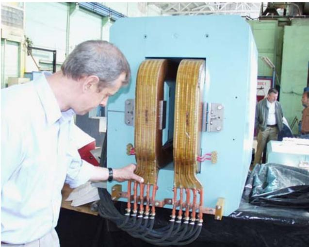
Abbildung 151: *Dipolmagnet TDC.*
