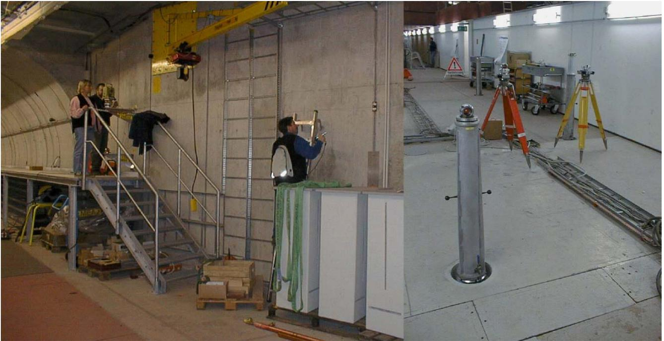
Abbildung 154: Netzmessung für TTF2.
