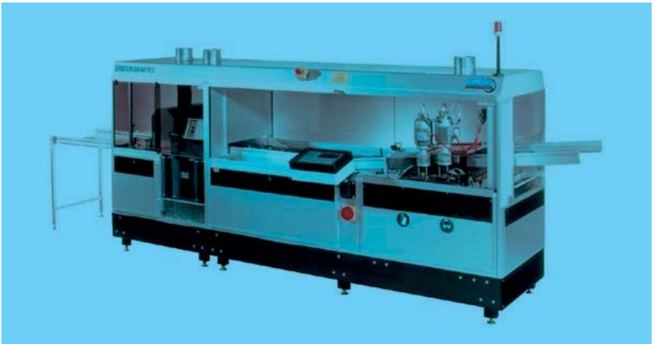
Abbildung 145: *Wellen-Lötsystem 8040 PCS.*
