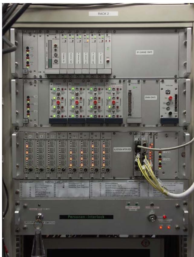
Abbildung 107: Rack mit Steuerelektronik für das Klystron-Interlock
