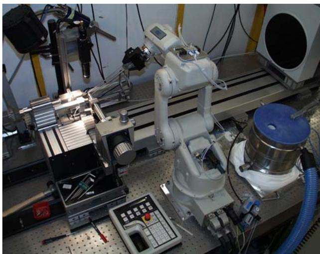
Abbildung 71: Der automatische Probenwechsler an BW7B. Zu sehen sind der Roboter, der Proben-Dewar mit angeschlossenem Nachfüllschlauch sowie der modifizierte kristallographische Messaufbau. Der zweidimensionale Detektor ist am oberen rechten Bildrand sichtbar.
