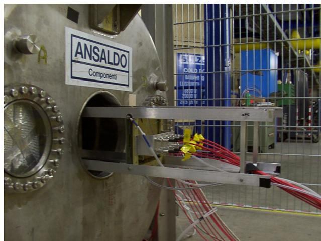
Abbildung 52: Test-TPC in der Öffnung des supraleitenden Magneten.
