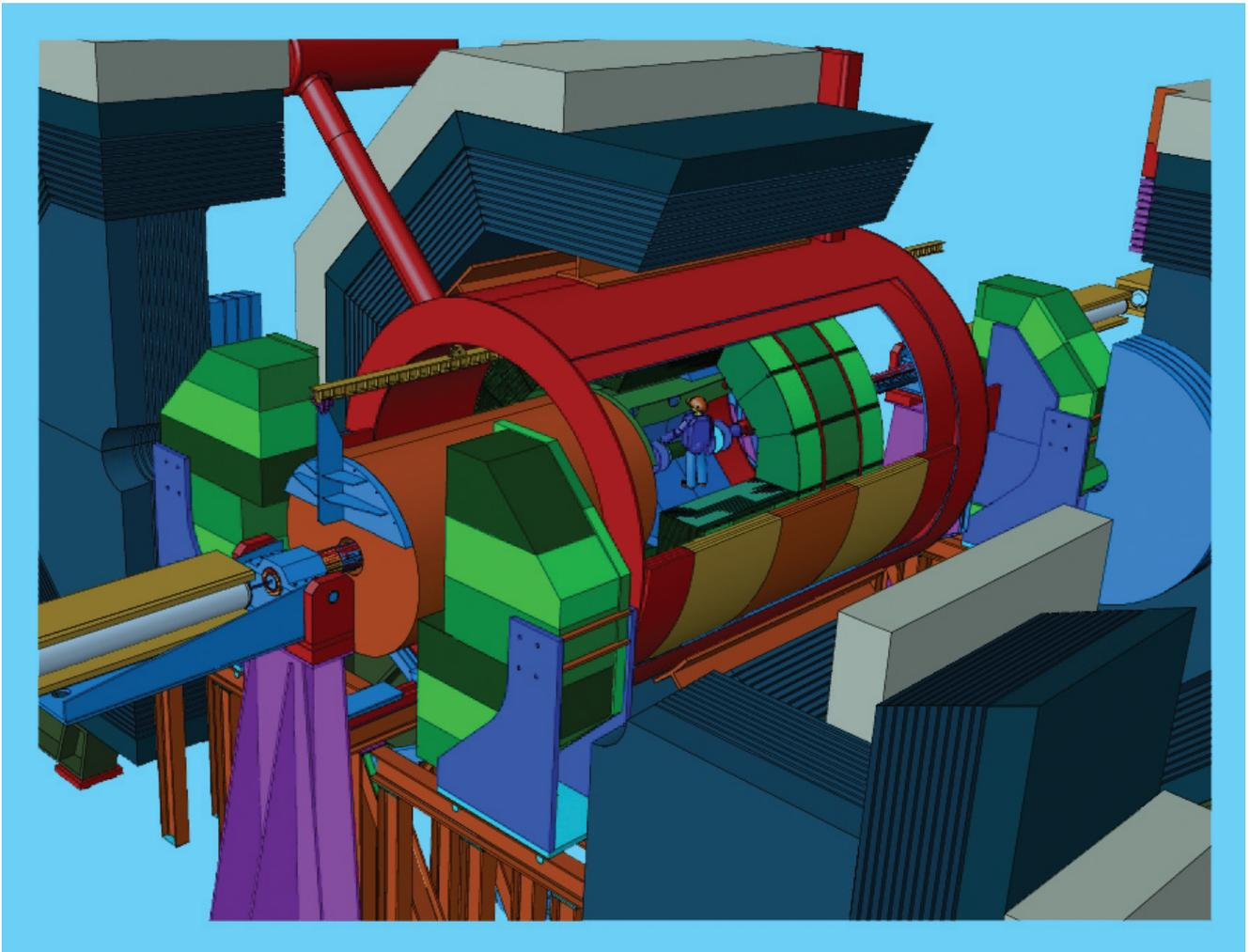
Abbildung 144: Zugang zum Innendetektor des TESLA-Detektors in Strahlposition.
