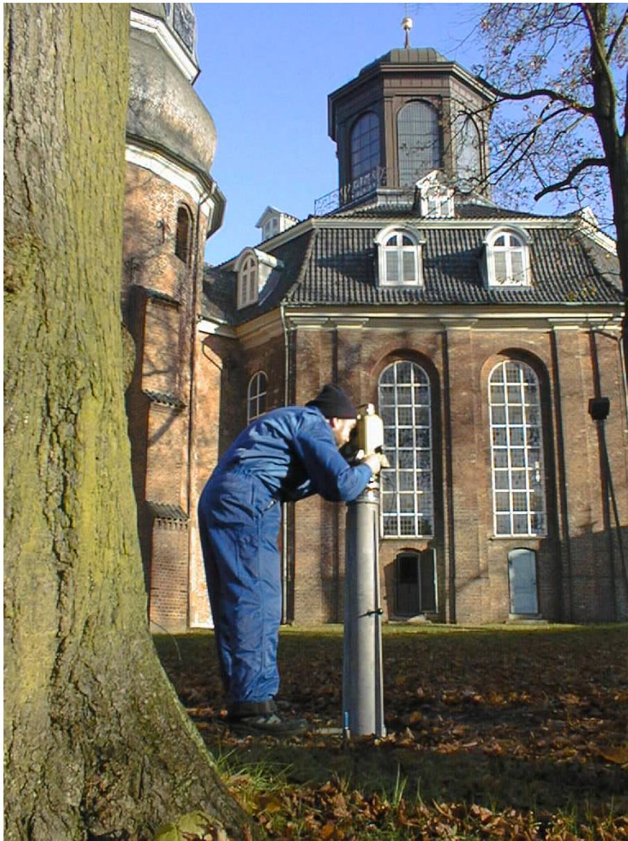
Abbildung 143: Sicherungsmessungen an der Rellinger Kirche.
