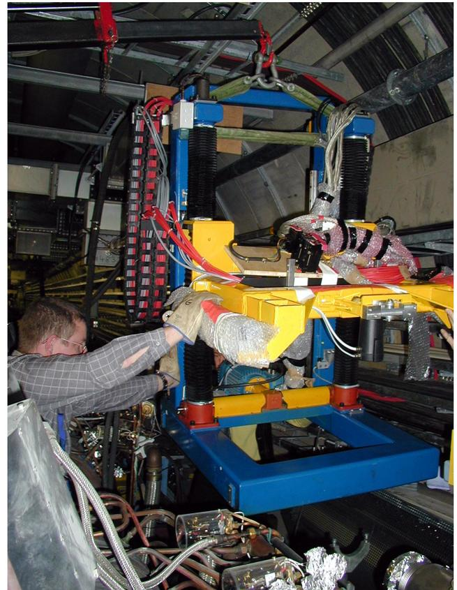
Abbildung 148: Einbau des Hubtisches für den H1-Photonendetektor.
