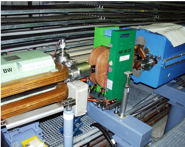
Abbildung 145: CZ-Magnet in HERA-NL vor Einbau der Vakuumkammer für den Elektronenstrahl.
