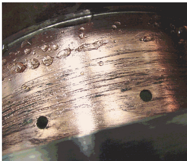
Abbildung 117: Links: 100 kW-3 1/8"-Koaxial-Absorber für Betrieb mit 30-prozentigem Glykol-Wassergemisch. Rechts: Wasserperlen durchdringen das poröse Kupfermaterial des koaxialen Außenleiters im Bereich des keramischen Fensters.
