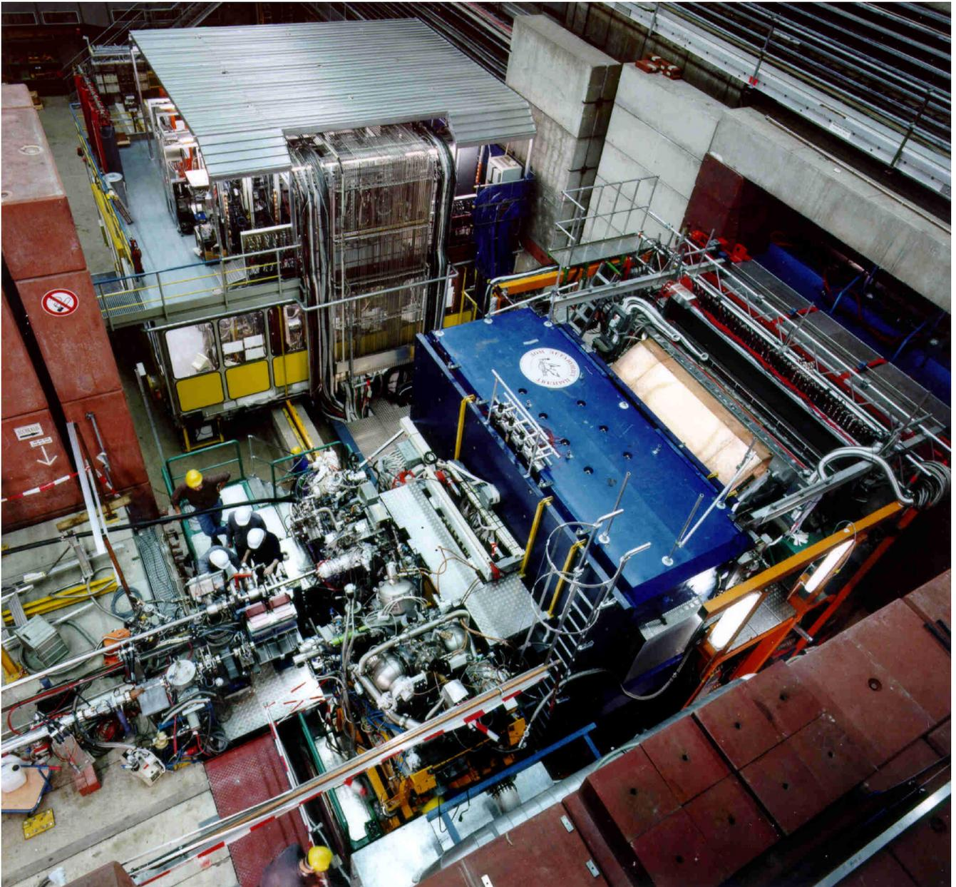
Abbildung 27: Blick auf das HERMES-Experiment mit dem Elektronikwagen im Hintergrund. In der linken Bildhälfte sind das Positronen-Strahlrohr und das polarisierte Target zu sehen. Neben dem Magneten in der Mitte des Experiments erkennt man in der rechten Bildhälfte den RICH und das Kalorimeter.
