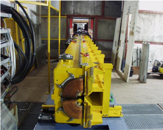
Abbildung 132: Montierter Halbquadrupol NL.
