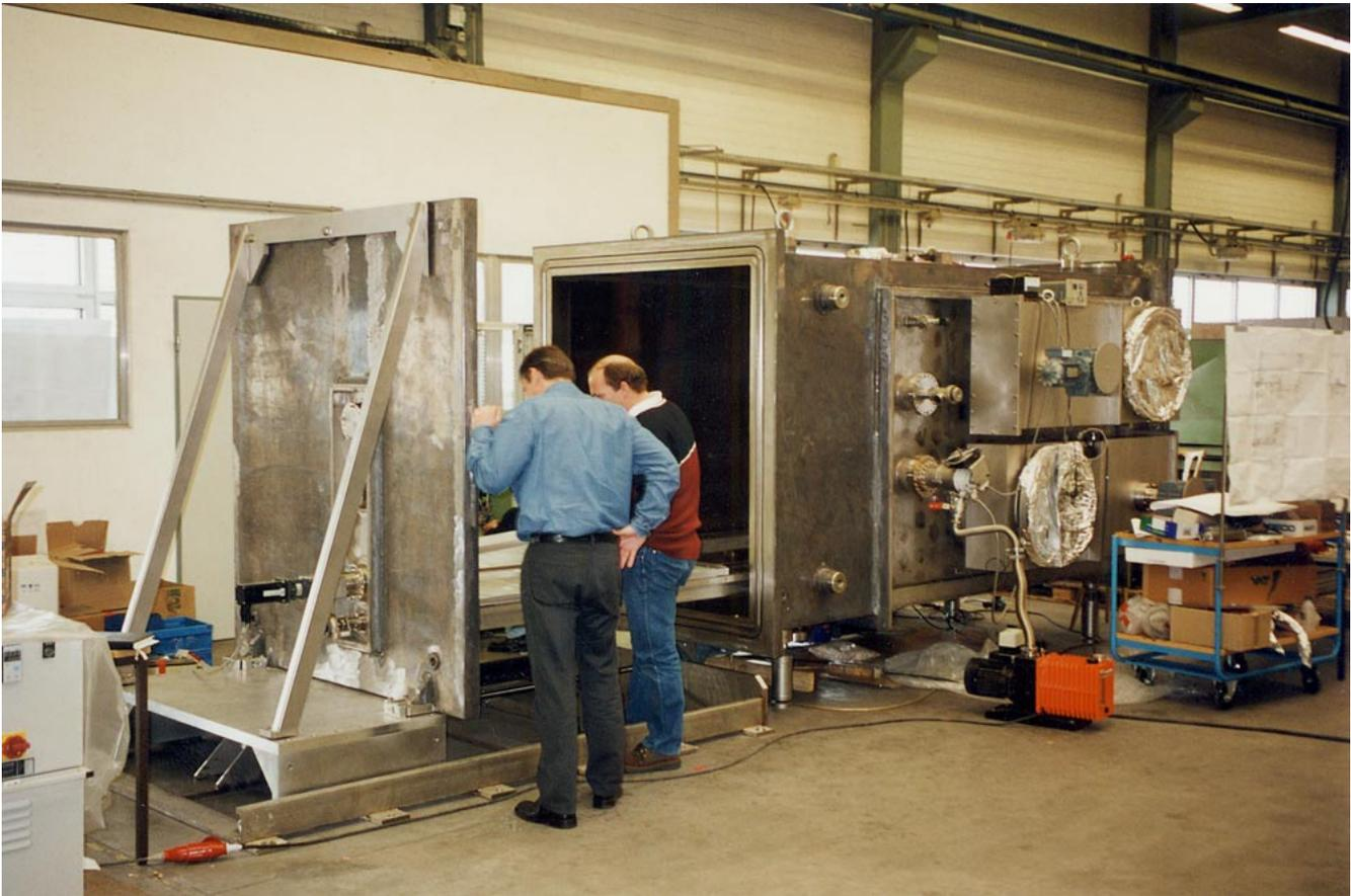
Abbildung 120: EB-Schweißanlage, Aufbau der Arbeitskammer.
