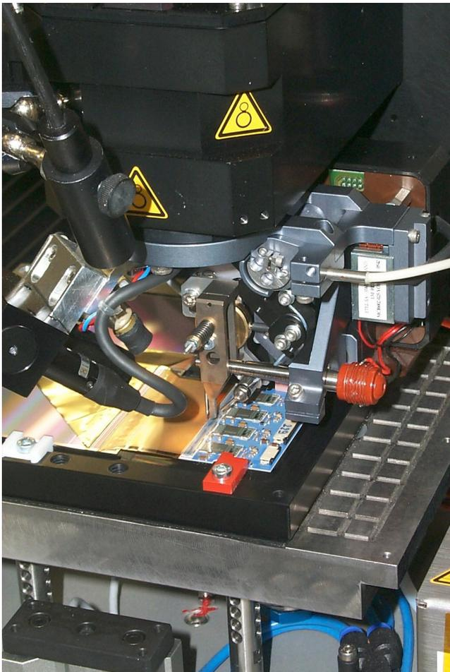
Abbildung 124: Bondautomat Delvotec 6400 im Einsatz beim Zeus-MVD.
