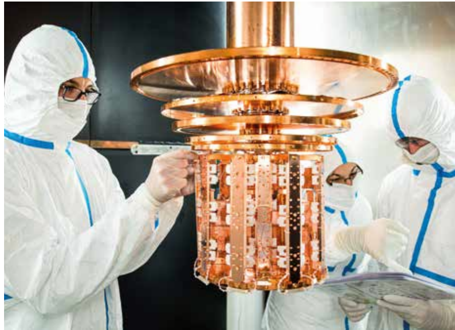
Das Experiment Cryogenic Rare Event Search with Superconducting Thermometers (CRESST) späht 1400 Meter tief im italienischen Gran-Sasso-Massiv nach winzigen Temperaturschwankungen, die durch eine seltene Kollision eines Dunkle-Materie-Teilchens ausgelöst werden können. Arbeiten am zentralen Detektorteil müssen unter Reinraumbedingungen stattfinden.
