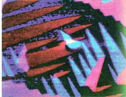
**Abb. 4.20** Aufnahme eines Fe-Kristalls mit einem Raster-Elektronen-Mikroskop. Die Farben entsprechen den verschiedenen Orientierungen der Weisschen Bezirke. Die typische Ausdehnung ist  $10^{-3}\text{m}$ .
