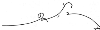
Abbildung 6: Myonloses Neutrinoereignis; in der Vergrößerung sieht man von links kommend das Elektron, das an Spiralisierung und harter Bremsstrahlung zu erkennen ist; aus [4]
