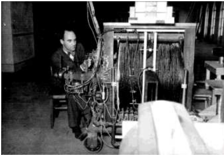
Abbildung 3: Carl Anderson und der Magnet der Nebelkammer zur Untersuchung kosmischer Höhenstrahlung im Guggenheim Aeronautics Lab, 1931, [8]
