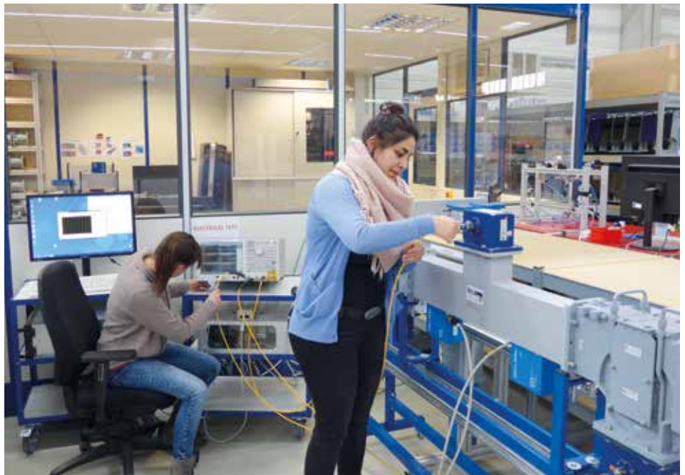
Zwei Mitarbeiterinnen des WATF-Teams bei der Messung und Abstimmung von Hohlleiterkomponenten.
