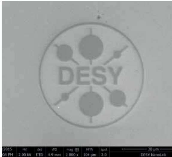
Rasterelektronenmikroskopiebild des DESY-Logos aus Platin, das mit einem feinen Elektronenstrahl auf eine Siliziumoberfläche geschrieben wurde. Mit dieser Technik werden im DESY NanoLab einzelne Nanoobjekte markiert, um sie im Röntgenstrahl von PETRA III zu untersuchen. Foto: Thomas Keller
