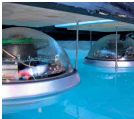
Detektoren für das Luftschauerfeld IceTop
