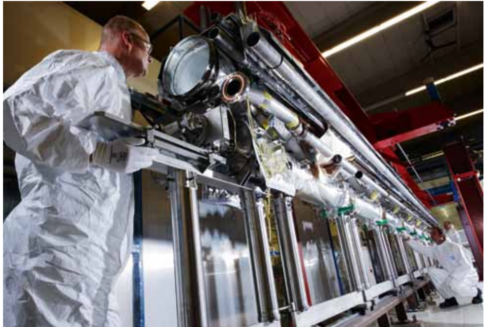
In DESYs Gebäude 28 werden die Resonatoren und die so genannte Kalte Masse montiert.
