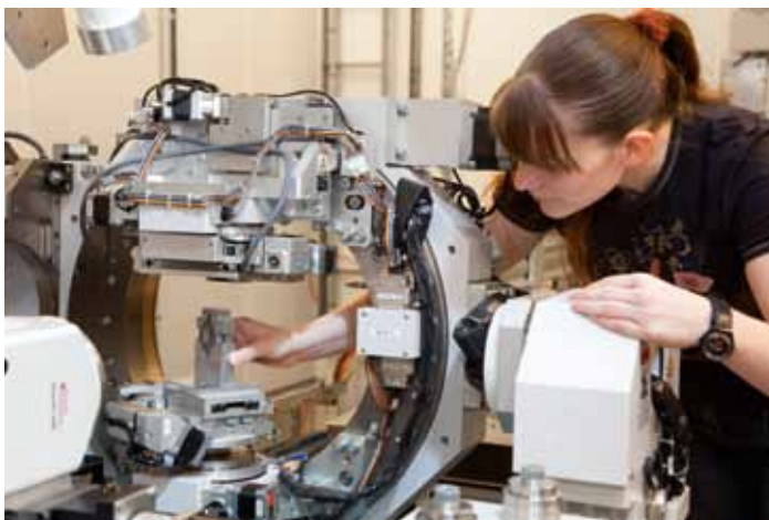
Beatrice Schuster (GSI) setzt eine Probe in das Diffraktometer von PETRA III-Experimentierplatz P09 ein.
