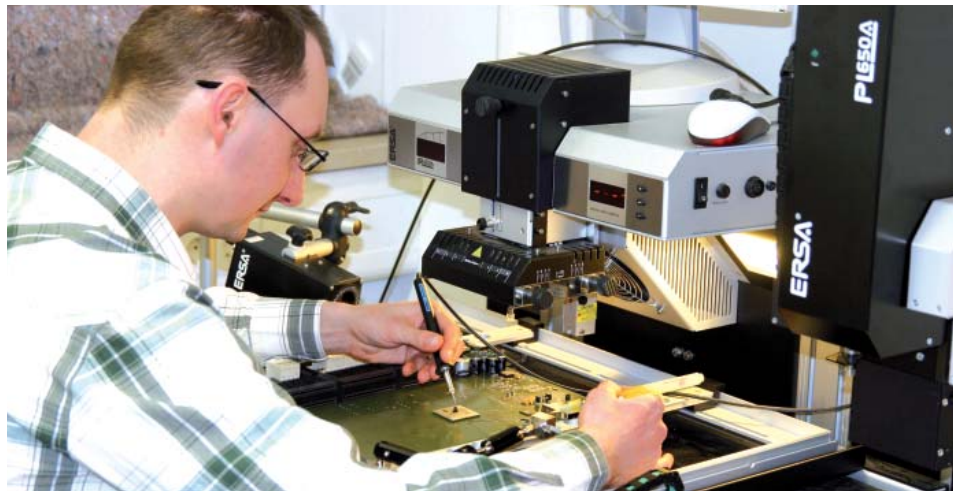
Ein ATCA-Board entsteht auf der Infrarot-Reflow-Lötstation.
