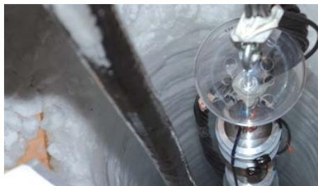
Installation einer SPATS-Trosse in einem IceCube Bohrloch am Südpol.
