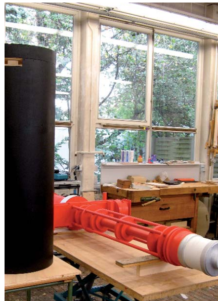
Power-tool der anderen Art: das Holz-Klystron (in rot) kommt später in den Mock-up-Tunnel.
