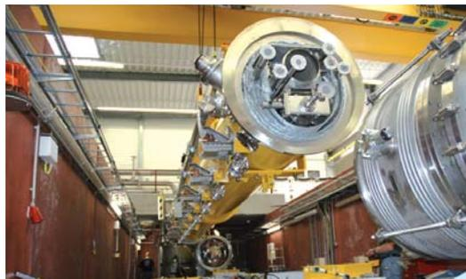
Modul 6 im neuen Teststand. Bald wird es in den FLASH-Linac eingebaut – ein wichtiger Schritt zu der Designwellenlänge von 6 Nanometern.
