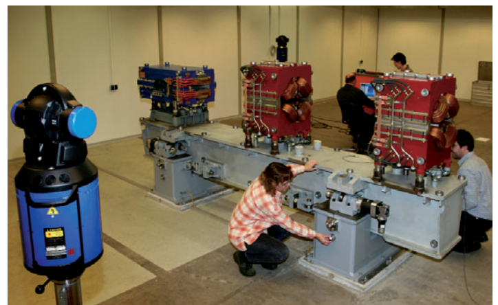
Feinjustierung eines Girders per Laser (links im Bild)
