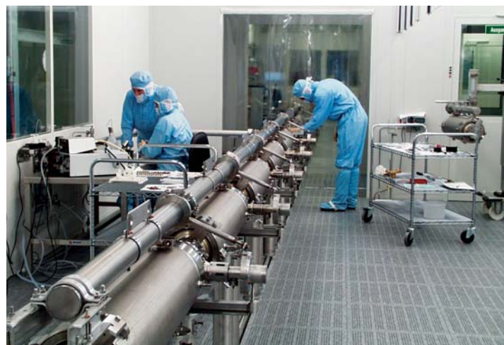
Montage der Cavities für Modul 6 im Reinraum.
