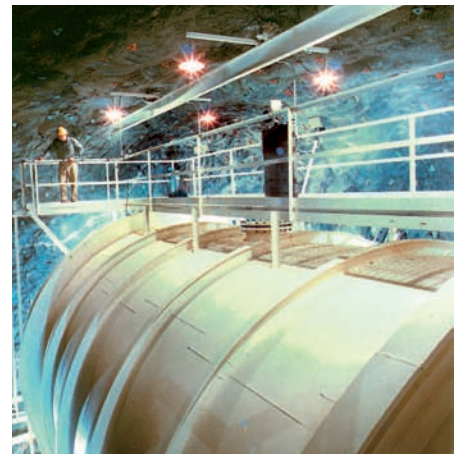
Abb. 15: Der amerikanische Physiker Ray Davis registrierte als Erster Neutrinos von der Sonne und stieß dabei auf das Sonnenneutrino-Rätsel. Sein Detektor bestand aus einem großen mit Tetrachloräthylen gefüllten Tank, in dem die Neutrinos bei Kernreaktionen wenige Argon-37-Isotope erzeugen, die mit einer hochsensitiven Methode nachgewiesen wurden. Davis erhielt hierfür 2002 den Nobelpreis für Physik.
