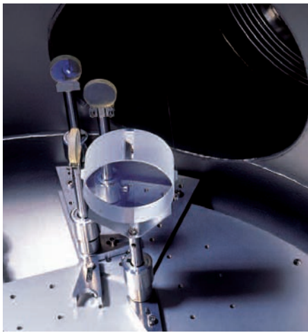
Der deutsch-britische Gravitationswellendetektor ist gleichzeitig Ideenschmiede und Versuchslabor für die technologischen Verbesserungen, die für die nächste Generation von Detektoren benötigt werden. Die bisher verfügbaren Technologien wurden an ihre Grenzen getrieben und weiterentwickelt: Laserstabilisierung, absorptionsfreie Optik, Regelungstechnik, Schwingungsdämpfung und Datenverarbeitung.
