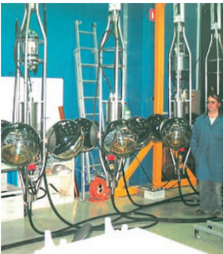
Fertig montierte ANTARES-Stockwerke im Labor
