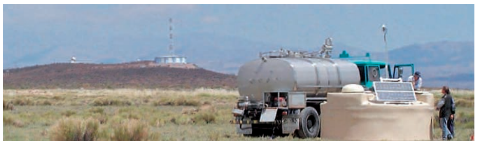
Füllen eines der 1600 Oberflächendetektoren des Auger-Observatoriums mit ultrareinem Wasser. Im Hintergrund ist ein Teleskopgebäude mit Kommunikationsmast und links davon eine Station zur Messung der Lichtabsorption in Luft (LIDAR) zu sehen.
