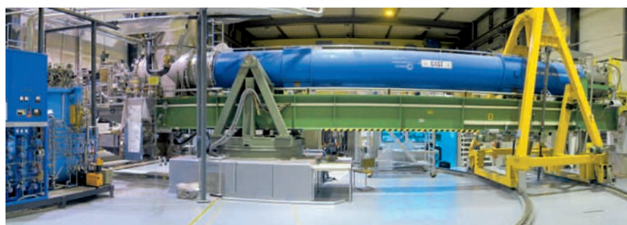
Oben: Der Aufbau des „Axionen-Sonnentelskops“. Unten: Der supraleitende Magnet von CAST (blaue Röhre), in dem sich Axionen in Röntgenstrahlung umwandeln sollen. Rechts erkennbar das Helium-Kühlsystem, das den Magneten auf 2 Kelvin abkühlt.
