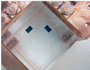
Ein Tieftemperatur-Kalorimeter des CRESST-Experiments: ein Saphir-Kristall mit aufgebrachtem supra-leitendem Film aus Wolfram. Der Kristall hat eine Kantenlänge von 4 cm und wiegt etwa 250 g. Er wird bei etwa 0,01 Kelvin betrieben.
