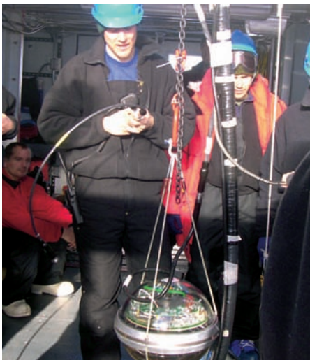
Installation eines Photomultipliers im antarktischen Eis.
