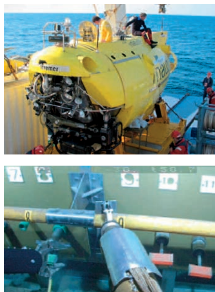
Oben: Bemanntes U-Boot „Nautilia“ kurz vor dem Einsatz; Unten: Verbinden eines der Strings mit der „Junction Box“.
