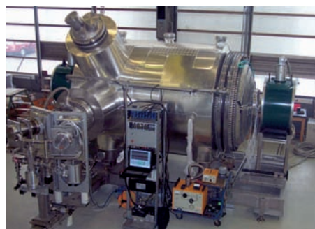
Das elektrostatische Vorspektrometer ist seit 2004 betriebsbereit und dient seither zum Test der Ultrahochvakuum-Techniken und der neuartigen elektromagnetischen Strahlführung.
