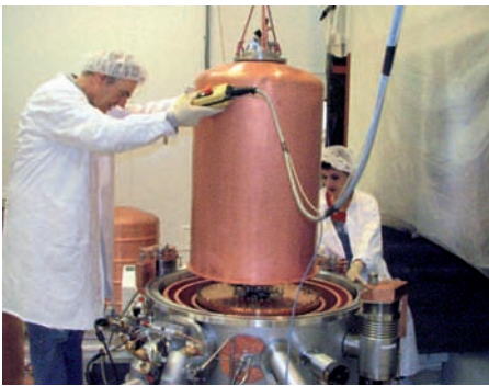
Testmontage der inneren von insgesamt drei Kupferhüllen des neuen Kryostaten mit einem Fassungsvermögen von 100 Litern für bis zu 110 Bolometer-Detektoren.
