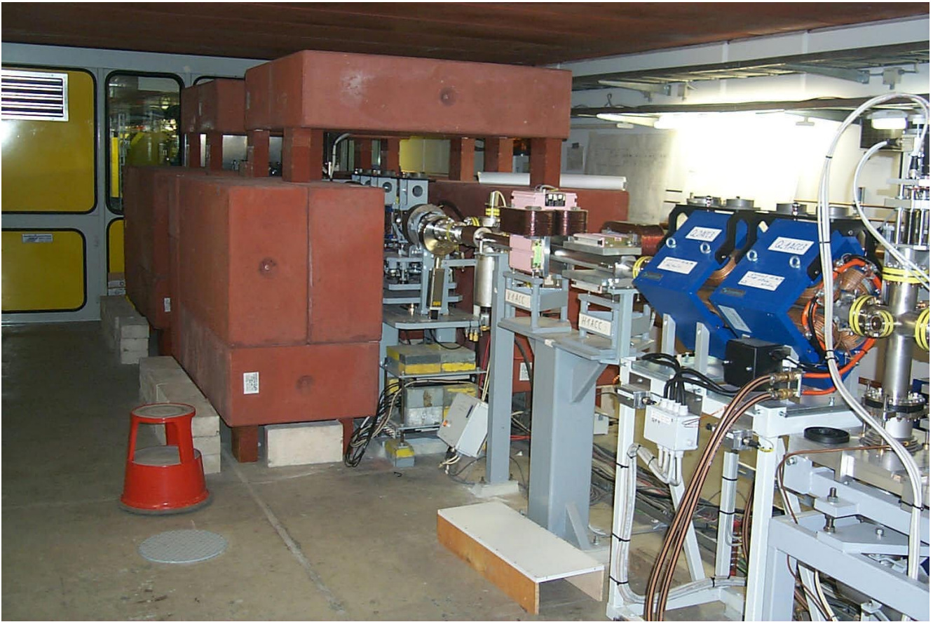
Abbildung 96: Das Kollimatorsystem schützt den Undulator vor unkontrollierten Teilen des Elektronen-Strahls. Im Hintergrund ist die Klimakammer für den Undulator zu erkennen.
