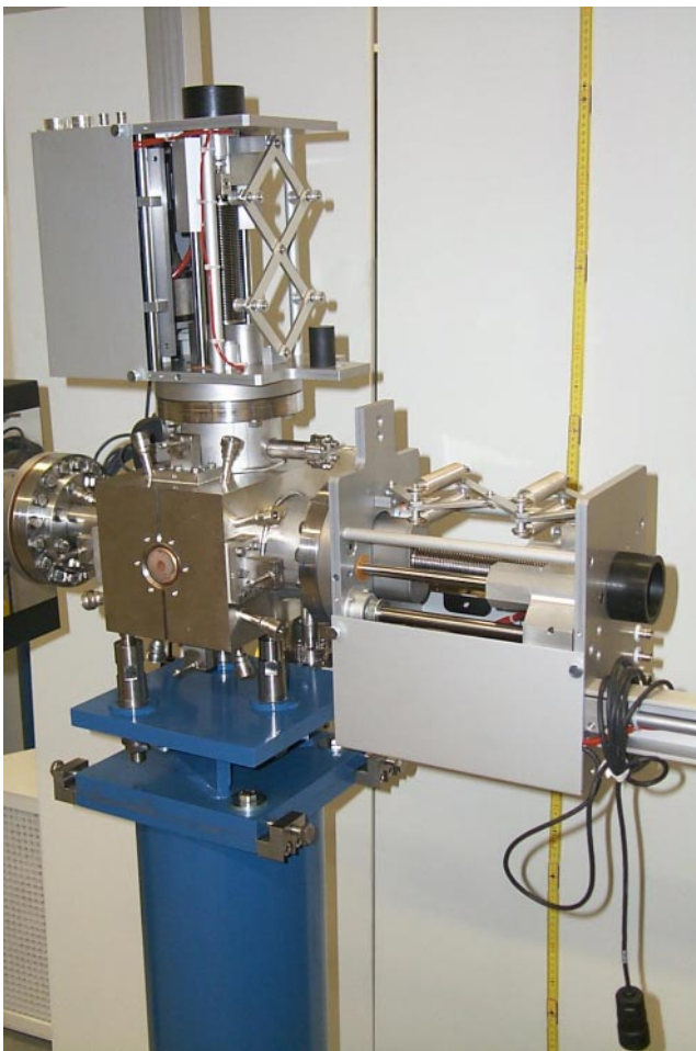
Abbildung 97: Der Monitorblock, der zwischen die Undulator-Abschnitte eingebaut wurde, enthält dünne Drähte, mit denen das Elektronen-Strahlprofil sowohl horizontal als auch vertikal auf besser als 10\ \mu\text{m} genau abgetastet werden kann. Das Foto zeigt die Vorrichtungen zum Fahren der Drähte, die an die Vakuumkammer angebaut sind.
