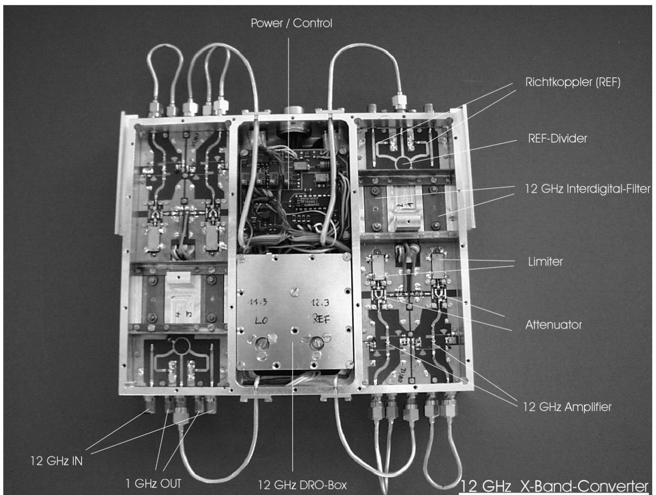
Abbildung 83: Baugruppe zum Verarbeiten von 12 GHz Signalen.
