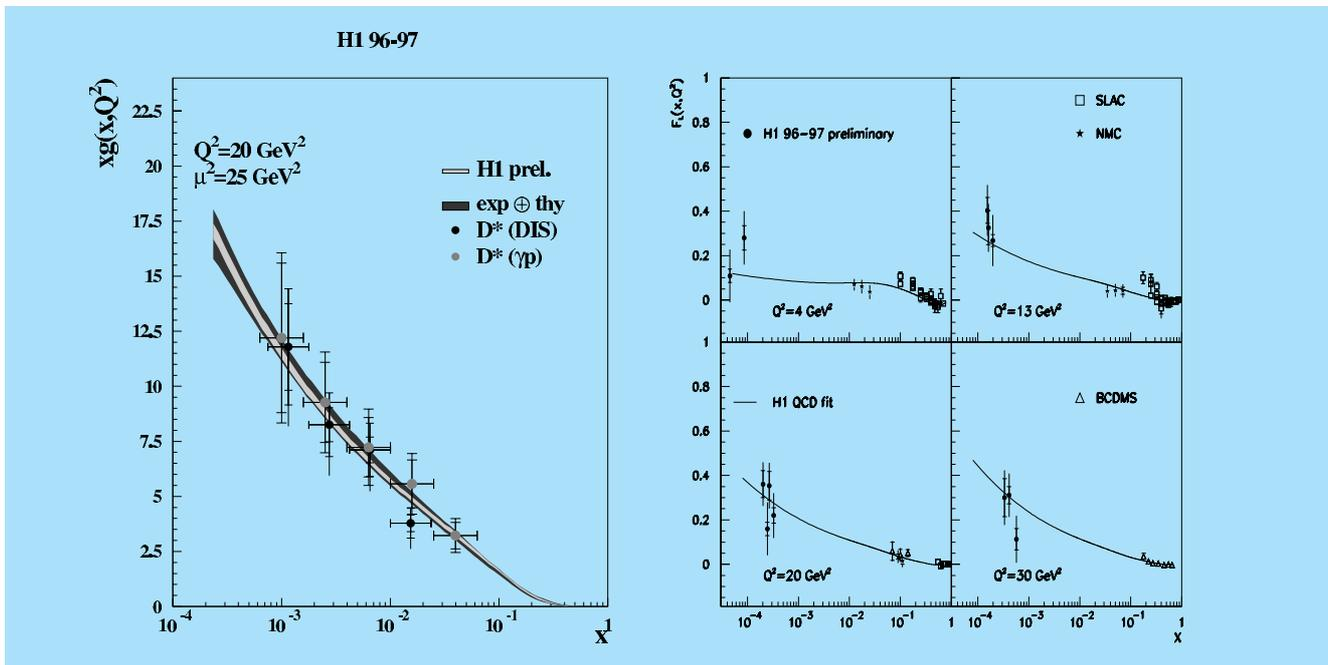
Abbildung 73: Bestimmung der Gluon-Impulsdichte  $xg$  (links) und der longitudinalen Strukturfunktion  $F_L$  (rechts) in einer Messung des inklusiven tiefunelastischen Streuquerschnitts der H1-Kollaboration.
