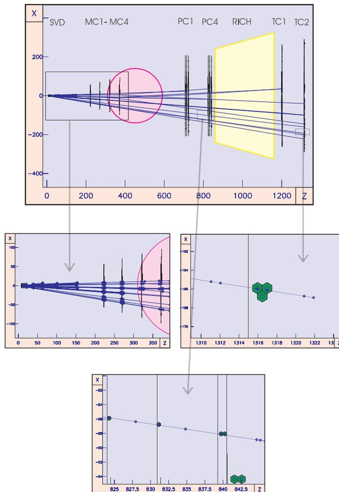
Abbildung 75: Spurrekonstruktion im Outer Tracker. Das obere Bild zeigt die Gesamtansicht vom Wechselwirkungspunkt bis zur letzten Spurkammerebene TC2. Die anderen Ansichten sind vergrößerte Ausschnitte: im Silizium-Vertexdetektor und in den Kammern MC1–MC4 (mitte links), Spuren in den hexagonalen Zellen von TC2 und PC4 (mitte rechts und unten).
