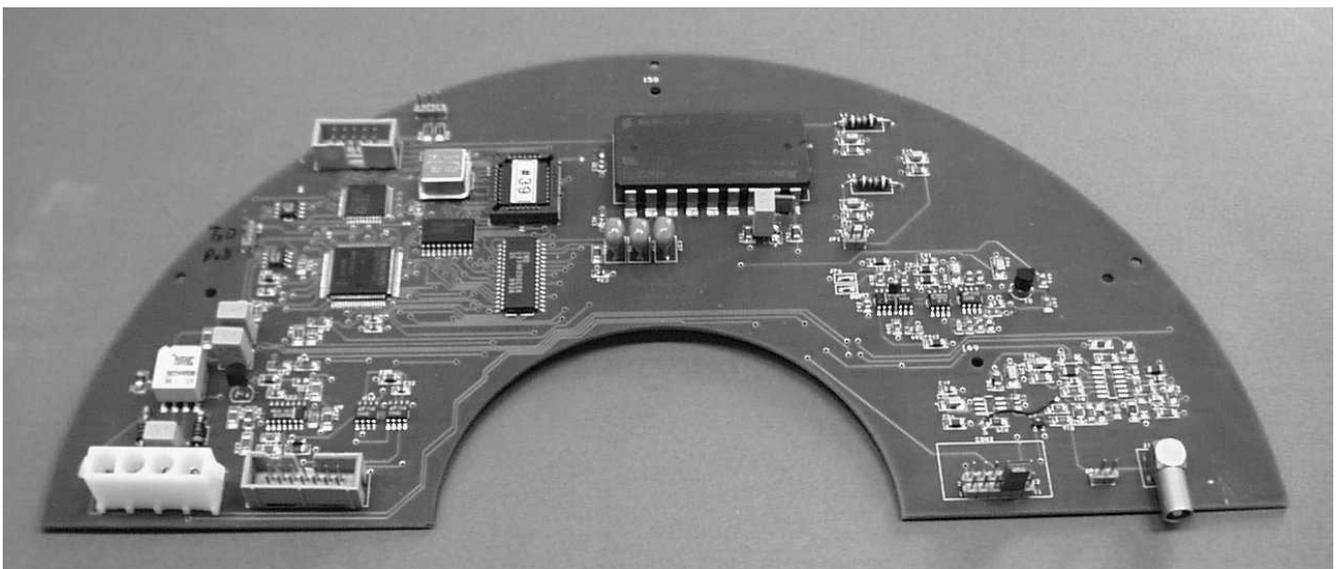
Abbildung 82: Leiterplatte für den digital gesteuerten Analog Optischen Modul (dAOM).
