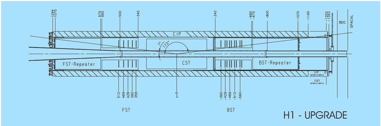
Abbildung 74: *r-z* Ansicht der Siliziumdetektoren BST und FST.
