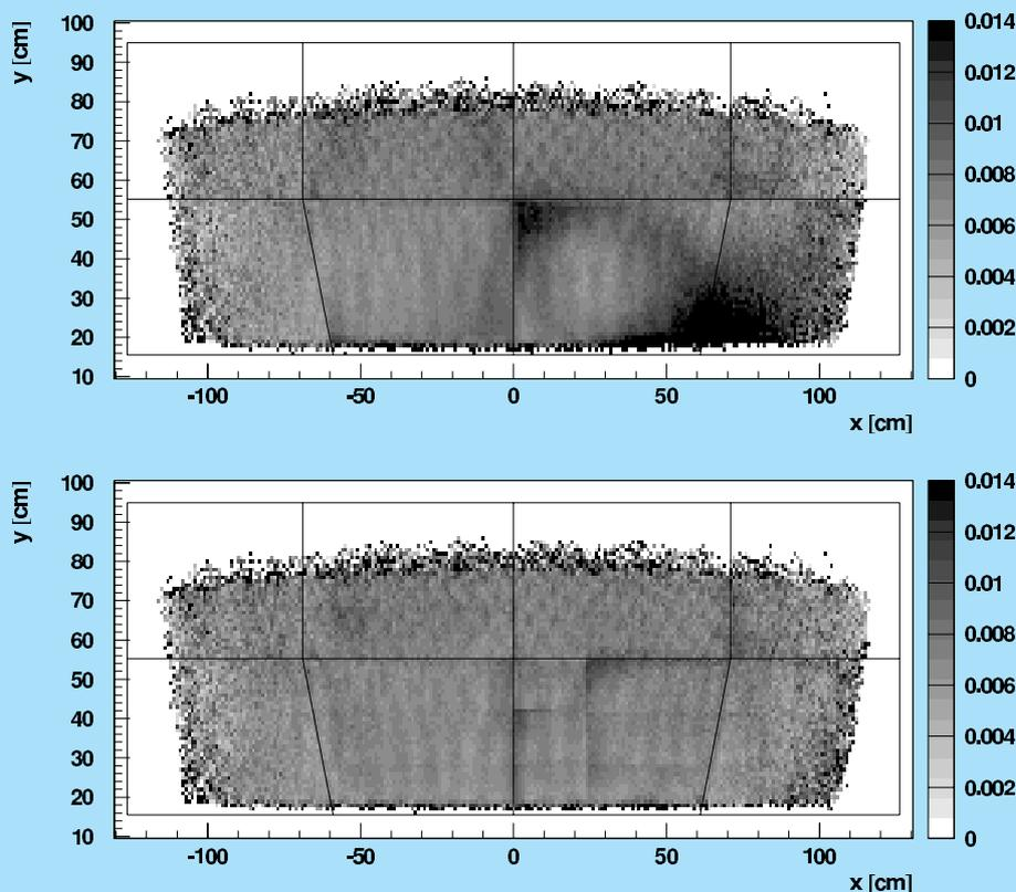
Abbildung 76: Die Genauigkeit der Spiegel-Fokussierung vor (oben) und nach der Software-Korrektur (unten). Die dunklen Stellen im oberen Bild zeigen, wo eine Abbildung durch den Spiegel verzerrt wird.
