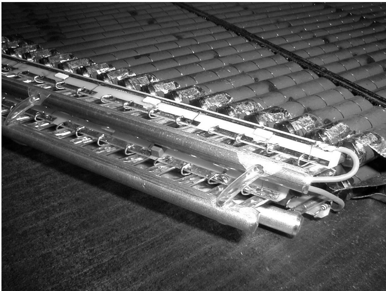
Abbildung 15: Teil eines STT-Sektors mit drei Lagen „Straw Tubes“. Die Hochspannungs- und Gasversorgung sind im Vordergrund.
