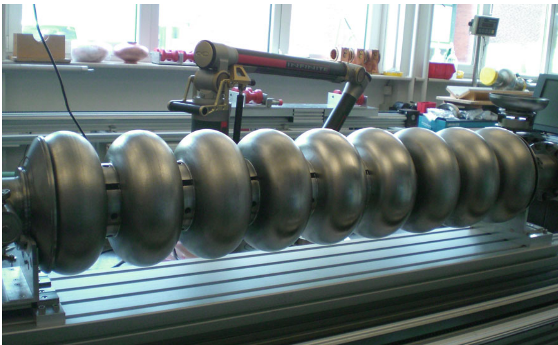
Abbildung 87: Patent erteilt: W. Singer, einer der Erfinder des Verfahrens und der Vorrichtung zur Herstellung von schweißnahtlosen Hochfrequenzresonatoren.
