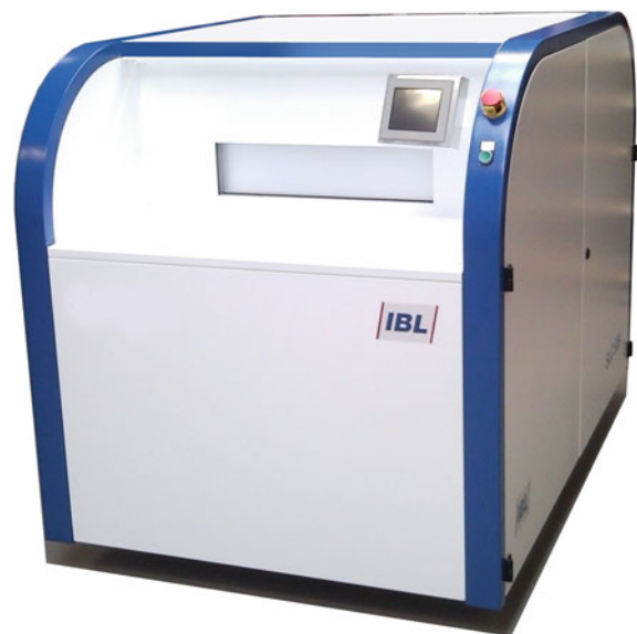
Abbildung 116: Neue Dampfphasenlötanlage IBL BLC 609.
