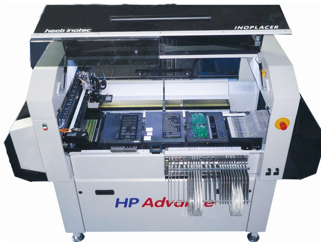
Abbildung 115: Neuer SMD-Bestückungsautomat Inoplacer HP Advance.
