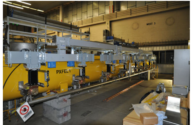
Abbildung 40: Der Beschleunigermodul-Prototyp PXFEL1 auf dem Teststand CMTB.
