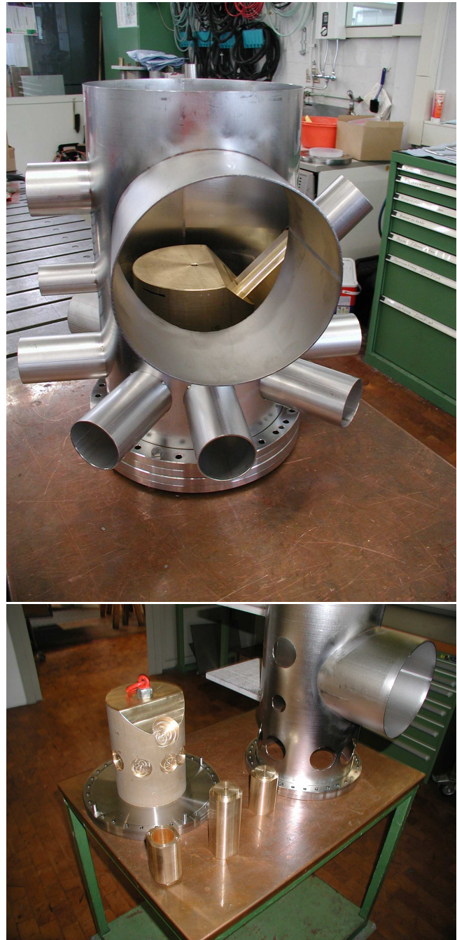
Abbildung 167: Bonfigt-Kammer mit Schweißvorrichtung .
