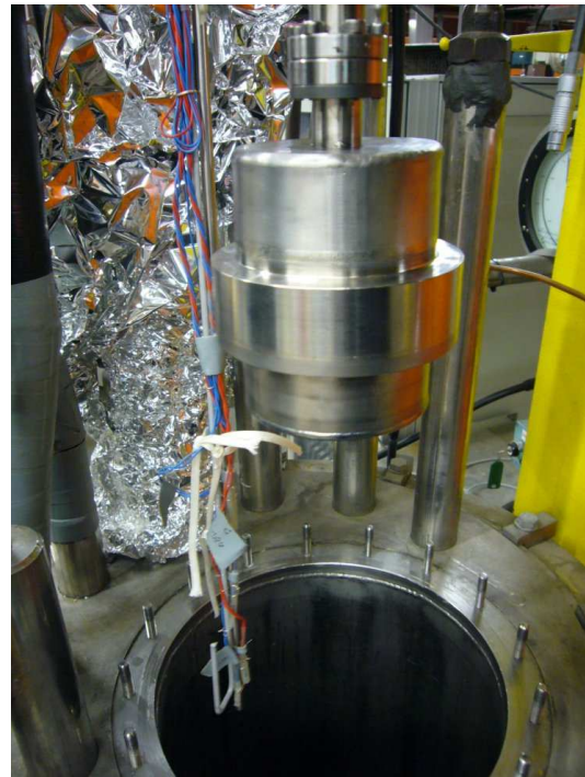
Abbildung 142: Titan-Edelstahlverbindung präpariert für den Einbau in den vertikalen Kryostaten V3.
