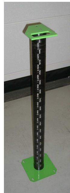
Abbildung 135: CFK Stütze für das HF-MoMo mit sehr geringem Wärmeausdehnungskoeffizienten.
