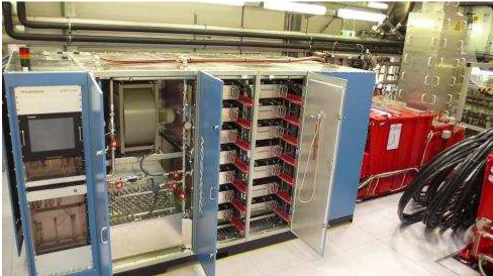
Abbildung 120: Der erste von zwei Modulator-Prototypen am Teststand in Zeuthen.
