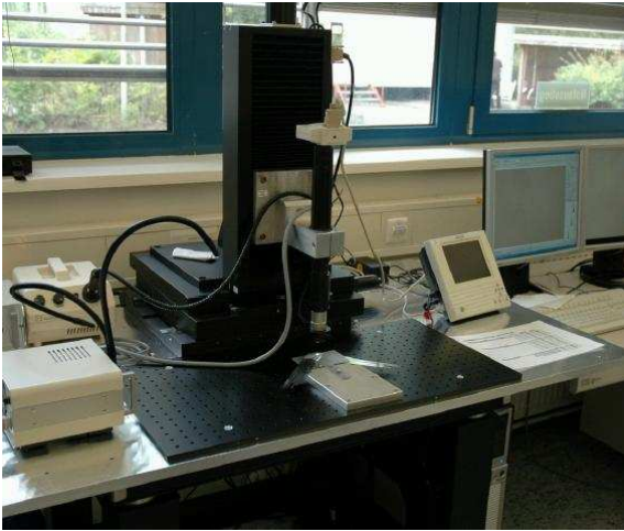
Abbildung 54: Präzisionsmesstisch zur Vermessung der Faserdetektoren.
