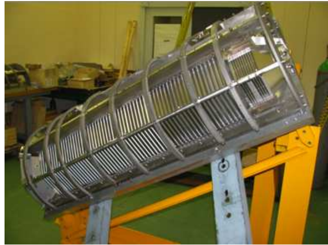
Abbildung 63: Photographie einer Hälfte des CASTOR Kalorimeters nach dem Befüllen mit Wolfram- und Quarz-Platten.
