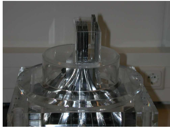
Abbildung 53: ALFA Prototyp in einer Plexiglas-Nachbildung des Roman Pots.
