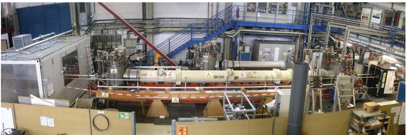
Abbildung 86: Das ALPS-Experiment sucht mit dem Licht-durch-die-Wand-Prinzip (oben) nach sehr leichten Teilchen jenseits des Standardmodells, die sehr schwach an Photonen koppeln. Das starke Magnetfeld des ALPS-Experiments wird durch einen supraleitenden HERA-Dipol geliefert (unten). Der Aufbau befindet sich in Halle 55 bei DESY in Hamburg, in der alle supraleitenden HERA-Magnete getestet wurden.
