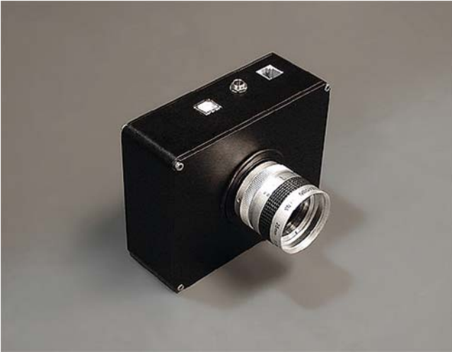
Abbildung 87: Die CCD Kamera SBIG ST-402, die beim ALPS-Experiment zum Nachweis der regenerierten Photonen verwendet wird.
