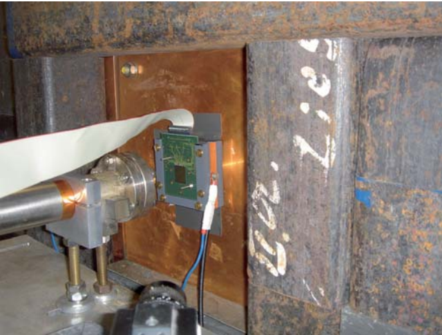
Abbildung 74: Ein MAPS Chip während der Bestrahlung mit Elektronen bei der GSI in Darmstadt
