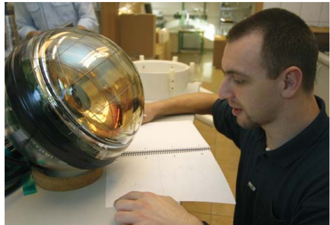
Abbildung 96: IceCube: optischer Modul nach der Montage in Zeuthen.
