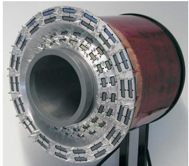
Abbildung 43: Bild vom fertiggestellten Detektor aus szintillierenden Fasern des HERMES Rückstoßdetektors.
