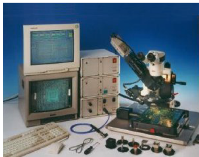
Abbildung 140: „Fineplacer“ zur Reparatur und Bestückung hochpoliger SMD-Bauelemente.
