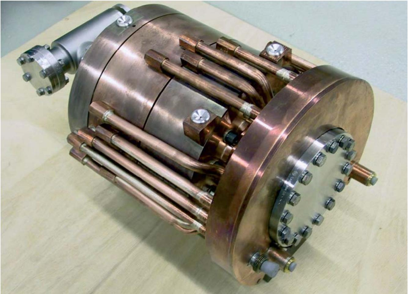
Abbildung 110: L-Band HF Kanone für den VUV FEL. Deutlich zu erkennen ist die aufwändige Verteilung der Wasserkühlung, die für die Temperaturstabilität der Kanone sehr wichtig ist.
