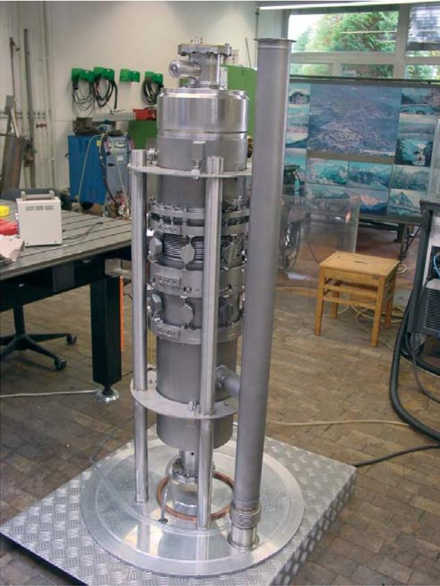
Abbildung 123: Tuner mit dem Resonator im He-Tank.
