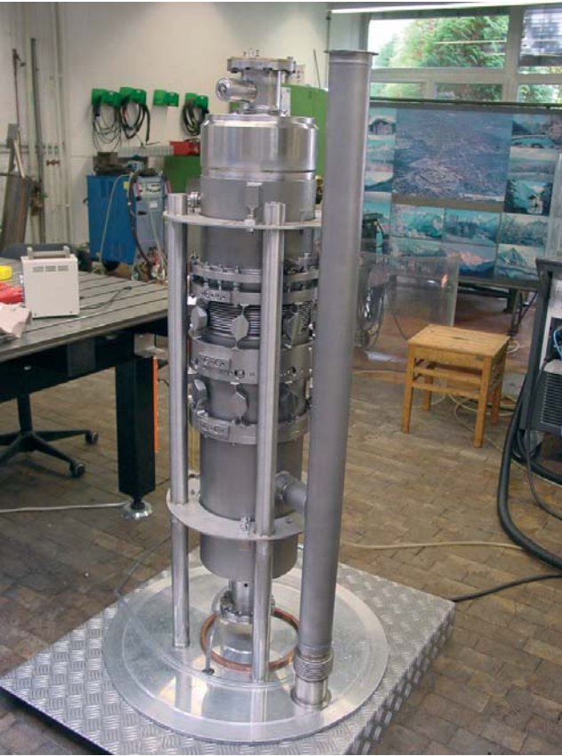
Abbildung 123: Tuner mit dem Resonator im He-Tank.
