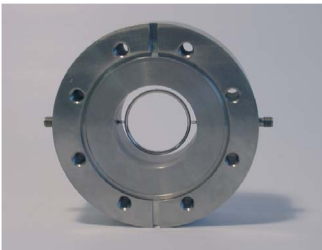
Abbildung 107: Phasenmonitor mit einer Auflösung von ca. 5 ps für TTF2. Die koaxiale Sonde ist in einem Flansch integriert.
