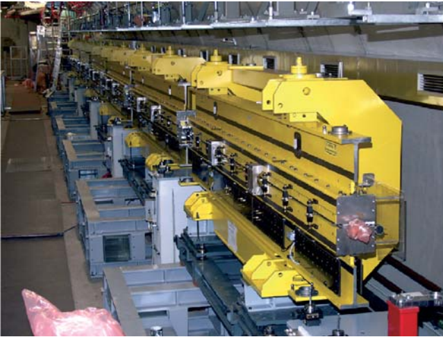
Abbildung 128: Die Undulatoren nach dem Einbau in die Tunnelanlage (links) und die Vermessung des Spektrometerbereiches durch die Gruppe MEA (rechts).
