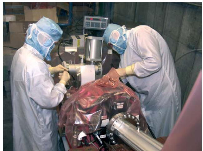
Abbildung 129: Montage von Vakuumkomponenten unter einem mobilen Reinraumzelt der Klasse 100.
