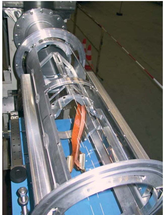
Abbildung 76: Streukammer mit Drehvorrichtung und der Hauptträger für die Siliziummodule.
