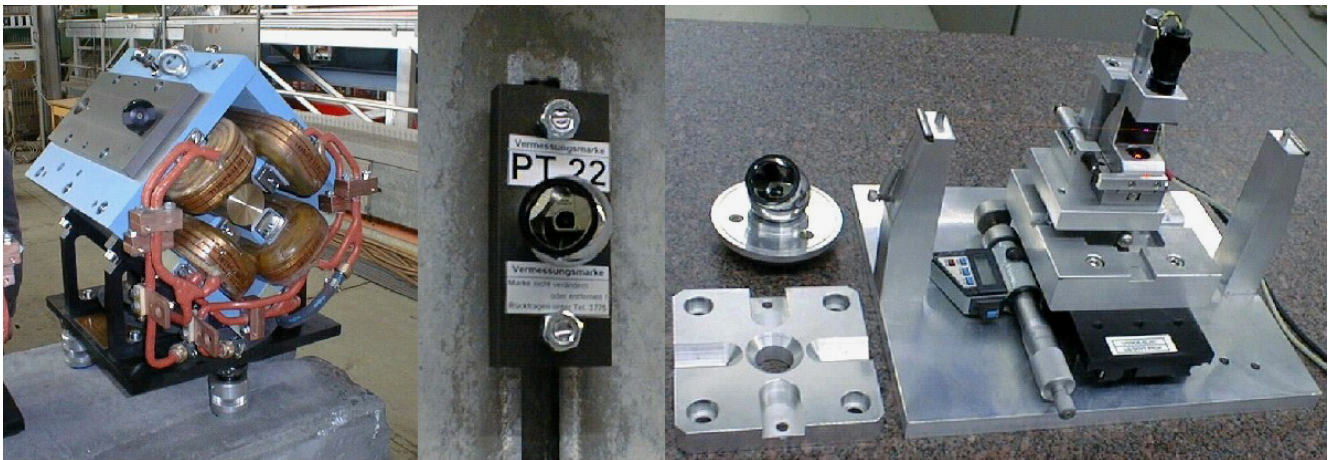
Abbildung 155: Messmarkenplatte für TTF2, Referenzmarke im Tunnel und Adapterplatte mit Wire-Finder.
