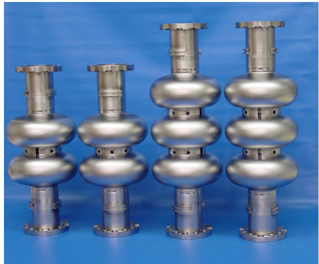
Abbildung 130: Dreizellige und zweizellige nahtlose Niob-Resonatoren, die durch IHU hergestellt wurden.
