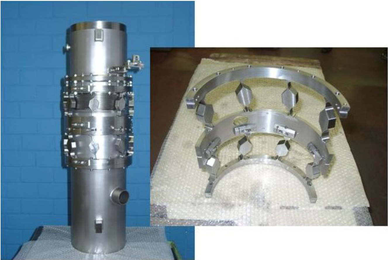
Abbildung 131: Links: Tuner mit dem Heliumtank; rechts: eine halbe Schale des Tuners.
