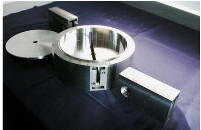
Abbildung 101: Neuartiger Monitor mit extrem guter Ortsauflösung für das Energiespektrometer bei TESLA.
