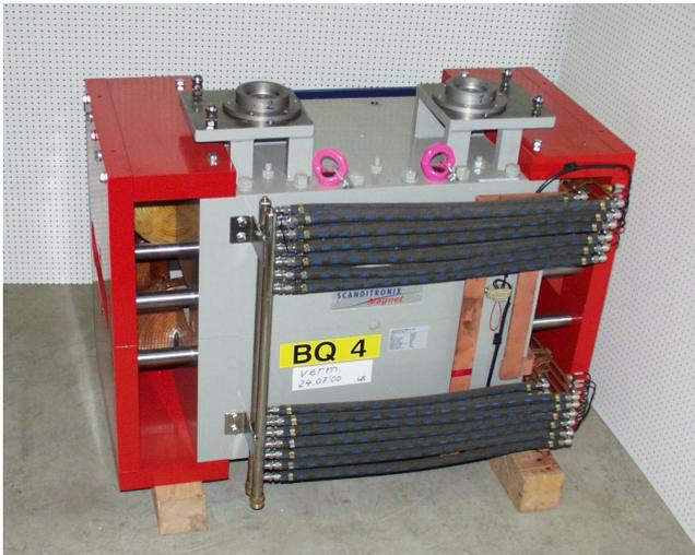
Abbildung 129: Dipolmagnet Typ BQ.
